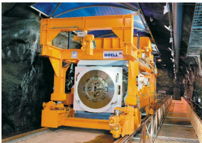
Figur 3-3. Demonstrationsanläggningen i Äspölaboratoriet med uppställd deponeringsmaskin.
