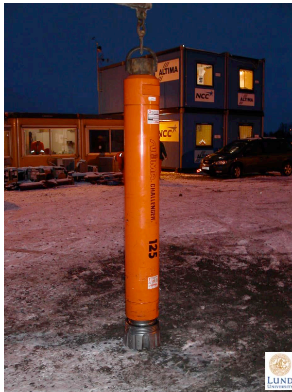
Fig. 13. Hammarborrutröstning med 12 1/4" borrhkrona använd i Lund 2003.
