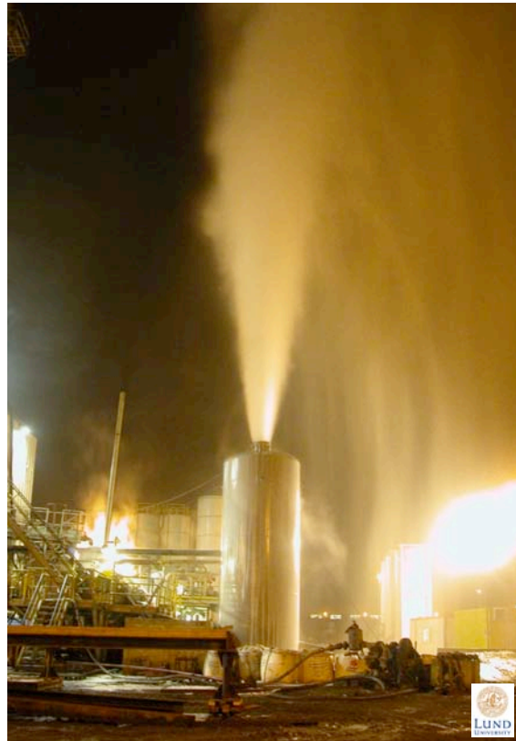
Fig.16. Evakuering av borrhål vid underbalanserad borrning.
