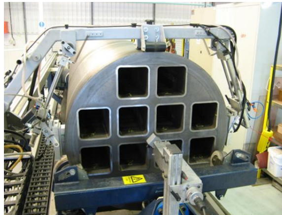
Ultraljudprovning av området mellan kanalrören på BWR-insats
